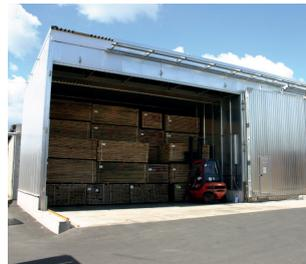
Sécher et traiter par haute température
