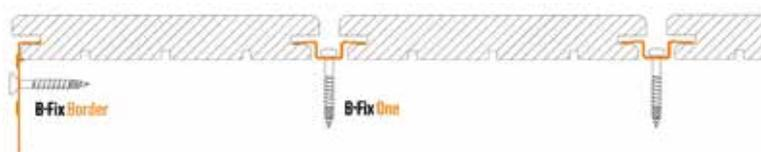
Fixation invisible pour des lames de largeur 120, 140 mm, et 21 mm d'épaisseur. Une finition impeccable, facile et rapide à poser, toujours démontable même les planches du milieu. Le clip garantit un jeu de 7 à 8 mm entre les lames.
